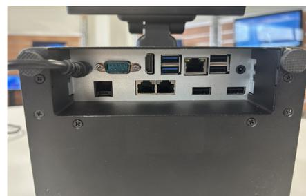
ACCÈS PORTS I/O DERRIÈRE BLOC PRINTER
